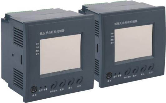
VPFZ系列无功补偿控制器是根据国家相关技术标准、规程和用户的实际要求，采用专用的电力参数采集芯片和32位ARM处理器设计开发的新一代低压无功补偿控制器。产品外形美观大方，安装使用方便。通过数码管显示和按键实现人机对话。通过485通读与VZNC系列智能集成电力电容器连接。控制物理量为电压、电流、功率因数和无功功率复合型。采用新型的无功趋势潮流判断算法，特别适用于功率因数变动大的场合。
