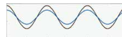
VSK 发出与谐波电流大小相等相位相反的谐波电流相互抵消
